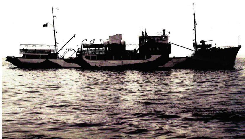
Figura 63: La fiancata di dritta della *Rovigno* mimetizzata. Si può notare sul ponte di castello la piazzola rialzata con il cannone da 76 millimetri e sopra la plancia due mitragliere da 20 millimetri (Collezione Fulvio Petronio)
